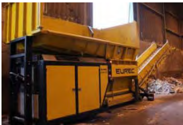
Abb.: Zerkleinerer für Sperrabfälle in der Umschlagshalle
