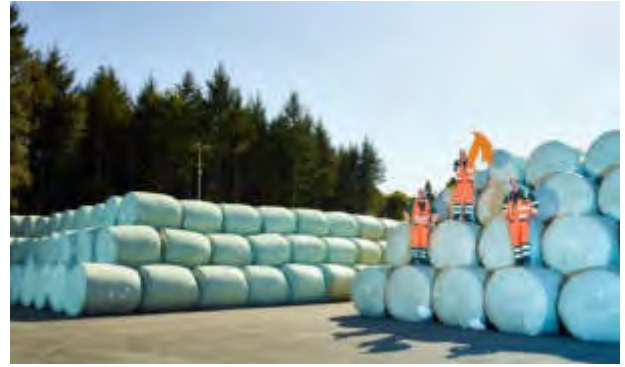
Abb.: Energiedepot – ballierter Restabfall im Zwischenlager
